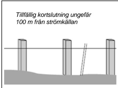
Som visas i figuren kan en bra tillfällig anslutning göras från staketledningen till jorden med t.ex. en järnstång ungefär 100 m från strömkällan. Anslut strömkällan till elnätet. Använd en digital spänningsmätare för att mäta jordstiftets värden. Spänningen vid jordstiftet får inte överskrida 0,3 kV eller 300 V.
