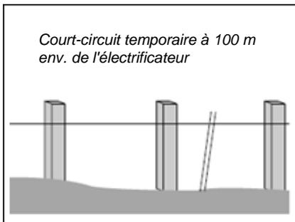
Comme présenté sur l'illustration, vous pouvez réaliser une connexion temporaire efficace du câble de clôture à la terre en plaçant un piquet en fer à une centaine de mètres de l'électrificateur. Raccorder l'électrificateur à l'alimentation électrique et utiliser un voltmètre numérique pour mesurer les valeurs du piquet de prise de terre. La tension sur le piquet de prise de terre ne doit pas dépasser 0,3 kV ou 300 Volts.
