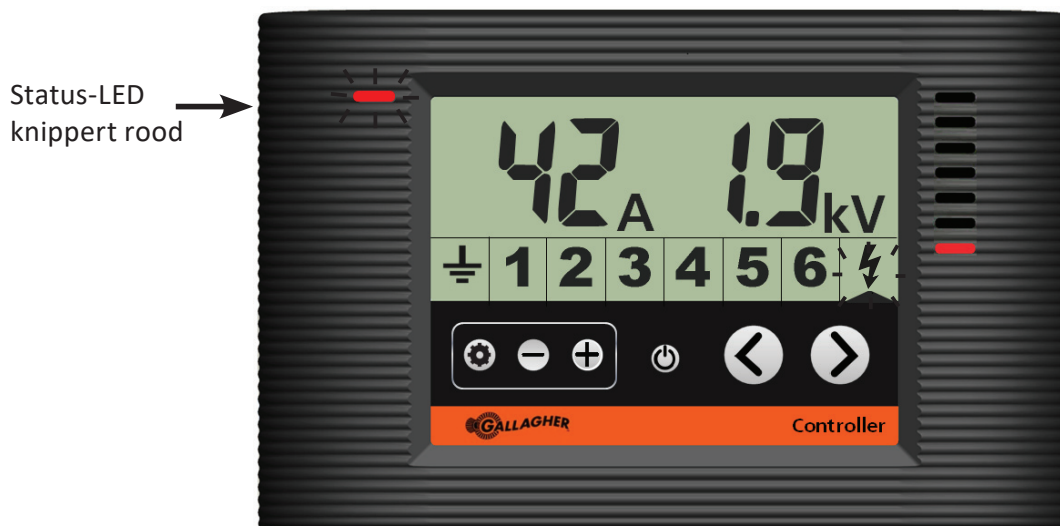
Bedieningspaneel toont het schrikdraadapparaat in stroomsterktealarm
