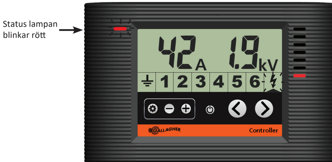
Kontrollen visar aggregat i ström larm
