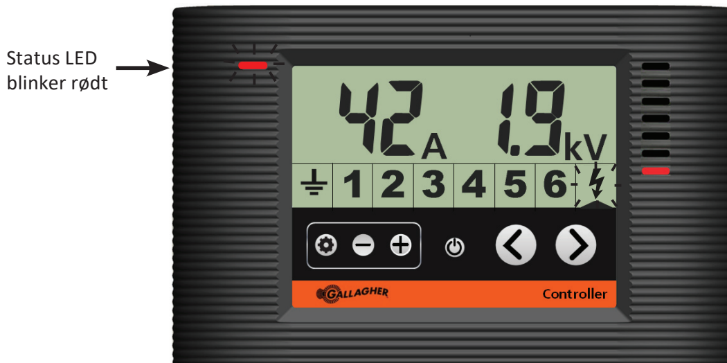
Styreenheden viser energizeren i strømstyrke alarm
